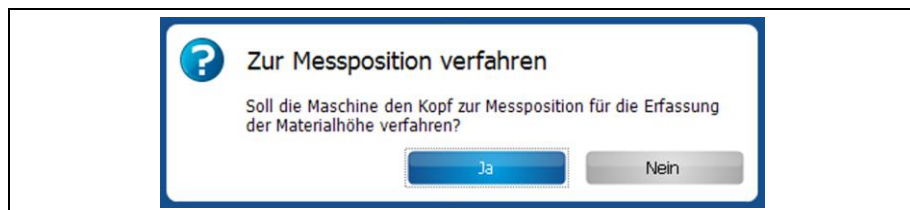
Abb. 48: Zur Messposition verfahren
