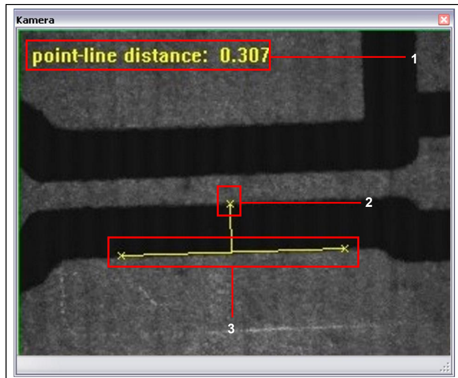
Abb. 406: Breite des Fräskanals
